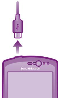
! Asegúrese de no doblar el conector al extraer el cable del teléfono.
