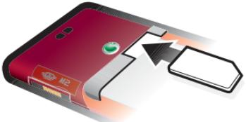
2 將 SIM 卡金色接點朝下插入卡槽。
